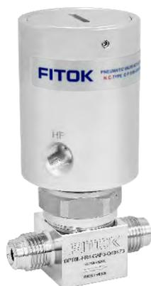
两段式气动隔膜阀 DPT 系列定位于高纯和超高纯应用，可在低流量和高流量间快速切换，实现设备的“软启动”，用来防止介质急骤流入工艺设备腔体而造成的压力骤然上升以及微粒飞扬污染腔体。
