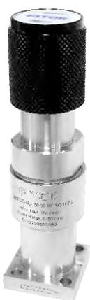
紧凑型联结隔膜减压阀 RTCC 系列，采用单级式减压设计，联结隔膜结构提供主动关断功能，浸润区无螺纹无弹簧，结构紧凑，适用于低流量的超高纯应用。
